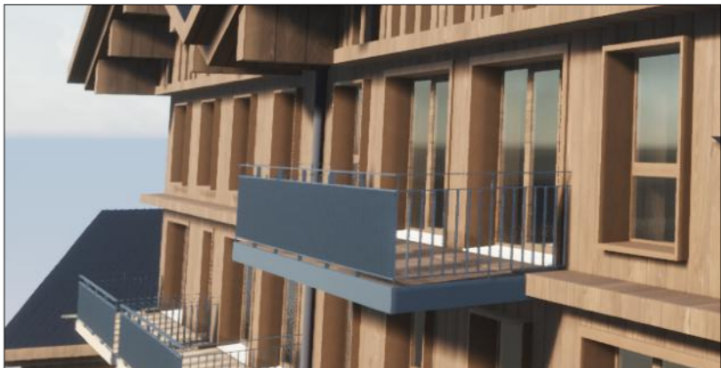
Garde-corps barreaudage métal + habillage nez de dalle tôle métal
